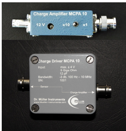
Verstärker mit Ladungstreiber sowie das Anwendungsprinzip des MCPA 10
